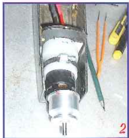
Particolare del gruppo motore/riduttore prima e dopo la modifica della parte anteriore con l'ordinata tonda atta ad alloggiare la nuova naca. Si evidenzia il supporto motore realizzato in nylon tornito.
