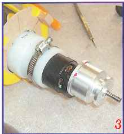
Particolare del gruppo motore/riduttore prima e dopo la modifica della parte anteriore con l'ordinata tonda atta ad alloggiare la nuova naca. Si evidenzia il supporto motore realizzato in nylon tornito.
