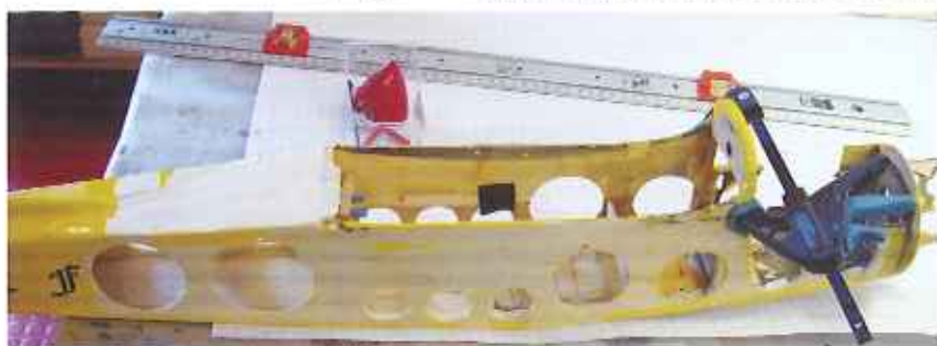
Incollaggio dei pezzi della fusoliera per ridare struttura al tutto. Colla e morsetti per l'incollaggio eseguito in parte con cianoacrilato in parte con resina
