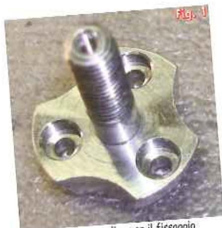
Albero portaelica per il fissaggio rovescio di un motore brushless
